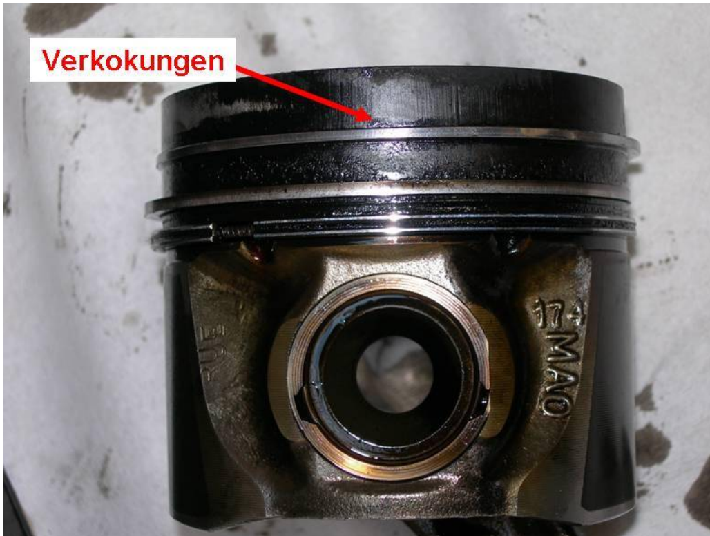
Bild 14 : Skoda Octavia: nach 100 000 km Pflanzenölbetrieb – ausgebauter Kolben
