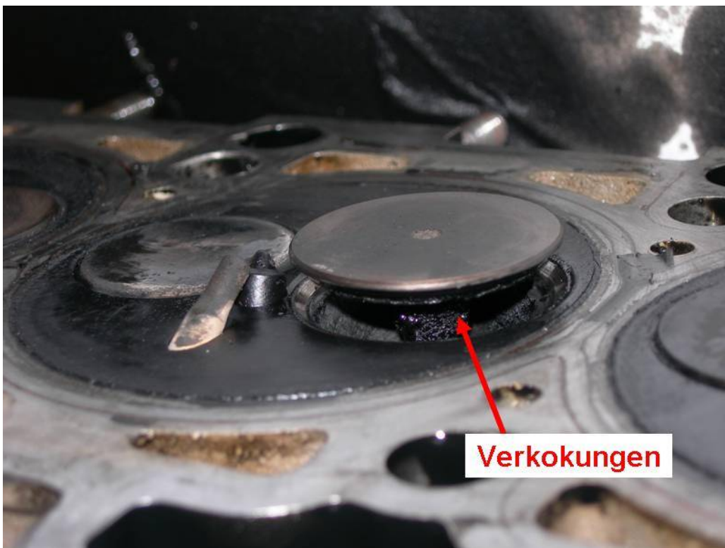
Bild 15 : Skoda Octavia: nach 100 000 km Pflanzenölbetrieb – Zylinderkopf mit geöffnetem Ventil
